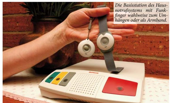
Die Basisstation des Hausnotrufsystems mit Funkfinger wahlweise zum Umhängen oder als Armband.
